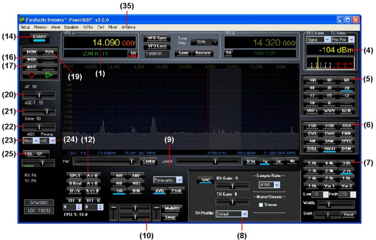
Рисунок 33. Органы управления передней панели для режима цифровых видов связи
