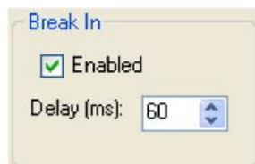
Рисунок 111. Управление полудуплексным режимом встроенного CW ключа
